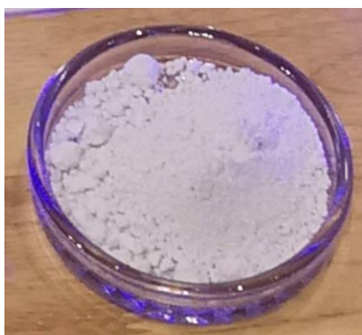
ภาพที่ 4 ผ่านกระบวนการทางความร้อนที่ 1,000 องศาเซลเซียส บดให้ละเอียดจึงนำมากรองด้วยตะแกรงร้อน
