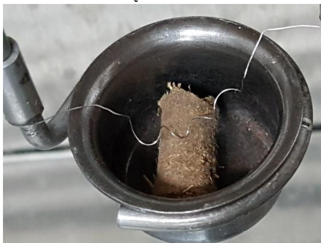
ภาพที่ 3 วัดค่าความร้อน (ASTM D240)
