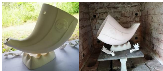
ภาพที่ 11 แสดงชิ้นงานเมื่อผ่านกระบวนการทางความร้อนที่อุณหภูมิ 800 องศาเซียสยังมีการดูดซึมน้ำได้อยู่
