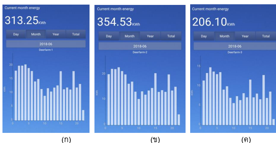
ภาพที่ 8 (ก) ผลการสอบวัดค่าพลังงานไฟฟ้า ที่เซลล์แสงอาทิตย์ผลิตได้ที่จุดที่ 1 กรงกวางด้านหน้าฟาร์มกวาง (ข) ผลการสอบวัดค่าพลังงานไฟฟ้า ที่เซลล์แสงอาทิตย์ผลิตได้ที่จุดที่ 2 กรงกวางด้านหลังฟาร์มกวาง (โรงเพาะเลี้ยงที่ 2) (ใช้กับปั๊มสูบน้ำ 2 เครื่อง) และ (ค) ผลการสอบวัดค่าพลังงานไฟฟ้า ที่เซลล์แสงอาทิตย์ผลิตได้ที่จุดที่ 3 อาคารแซ่เนื้อกวาง
